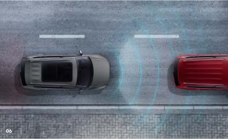
04 Lisää mukavuutta, myös ruuhkassa. Ruuhka-avustin mahdollistaa miellyttävän ajamisen ruuhkaisessa jonossa ja auttaa välttämään tyypillisiä ruuhkaonnettomuuksia. 1) Järjestelmä pitää auton oikealla kaistalla ja käyttää automaattisesti kaasua ja jarrua. 1)
